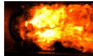
低NOx燃料ノズル着火試験
