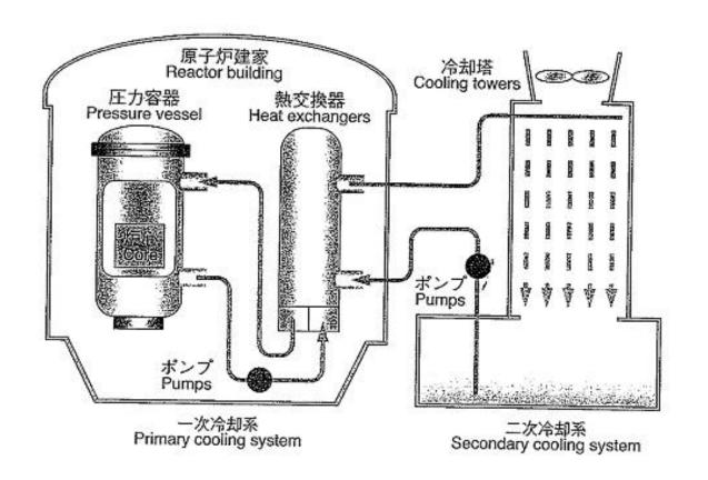
日本原子力研究所 JMTR 冷却系統概略図
