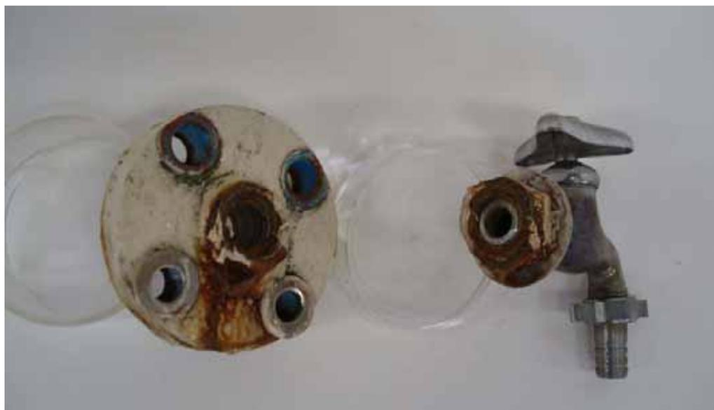
図4 蛇口部分の腐食
