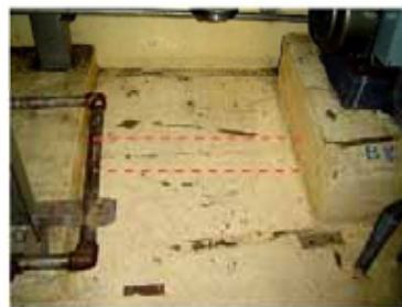
⑤ひび割れ (w=0.25mm、L=800mm)
