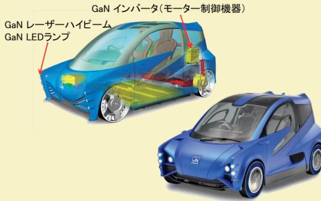
GaNを用いた電気自動車の概要図(左上)及び東京モーターショー2019に出展した実機(右下)
