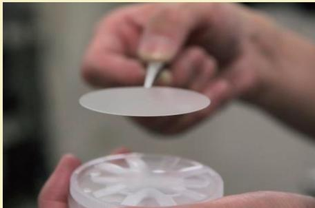
欠陥の少ないGaN結晶のウエハ（半導体物質の結晶でできた円形の薄い板）
