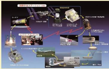
小型回収カプセルの運用概要図
