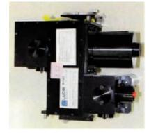
従来大型・高価だった脳内イメージング装置について、大学の有する脳内イメージングシステムを企業と共同で機器間の結合効率を向上させることで、安価・小型化を達成。可搬性の付与により、検査範囲も拡大。
