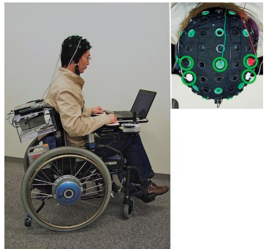
脳波で車いすをリアルタイム制御するBMI 提供：理化学研究所
