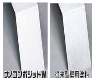
暴露12ヶ月後での比較。 （左）新塗 （右）従来塗料 （企業ホームページより）
