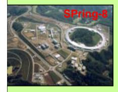
光速近〈まで加速した電子を曲げたときに発生する高輝度の電磁波(放射光)を、材料科学や生命科学等の様々な分野で利用平成9年10月に供用を開始。共用及び専用ビームライン等を合わせ34本のビームラインが稼働し本格的な研究活動を展開
