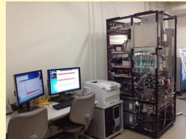
試作した次世代質量分析装置 提供：株式会社島津製作所
