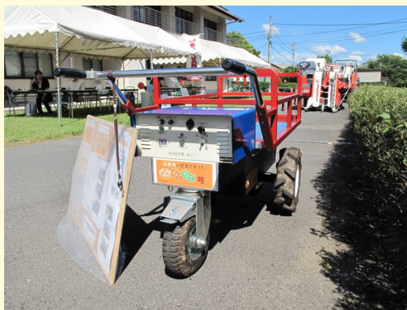
資料：開発した柿果実運搬のための電動農作業車 提供：科学技術振興機構 社会技術研究開発センター
