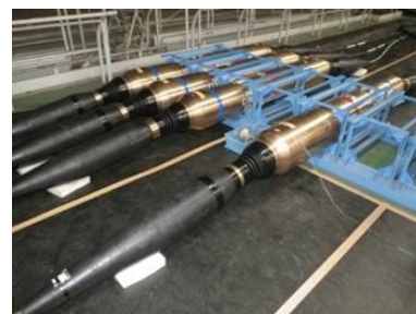
ケーブル式海底観測装置 (地震計・水圧計) 提供：文部科学省
