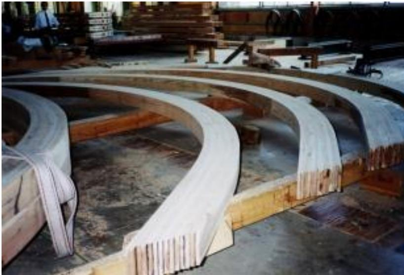
構造用集成材-接着・曲げ加工
