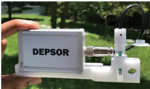
多数の重金属(鉛、カドミウム、水銀、ヒ素、銅、亜鉛)を数分で同時に試験するための DEPSOR-M
