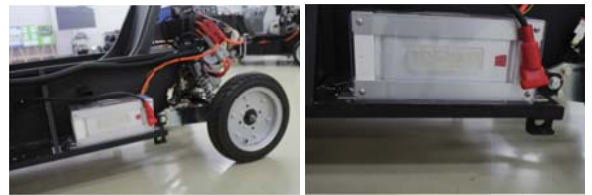
試作小型EVに搭載した電池試作品と、その拡大写真
