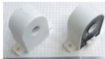
高性能直流電流センサの試作品 中心の穴に測定電流が流れる電線を通して使用する。
