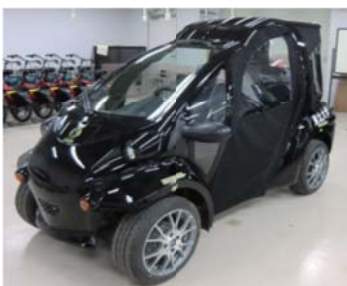
2人乗り小型電気自動車の試作品 右上のマンガン系リチウムイオン電池を搭載
