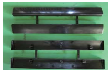
試作した自動車用樹脂成形部品 長さ 900mm
