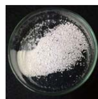
放射性物質 汚染水処理用吸着剤
