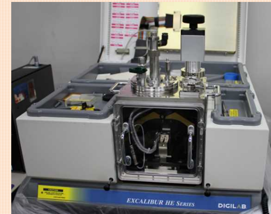
図1-8 放射率測定装置に組み込まれた温度依存性測定装置
