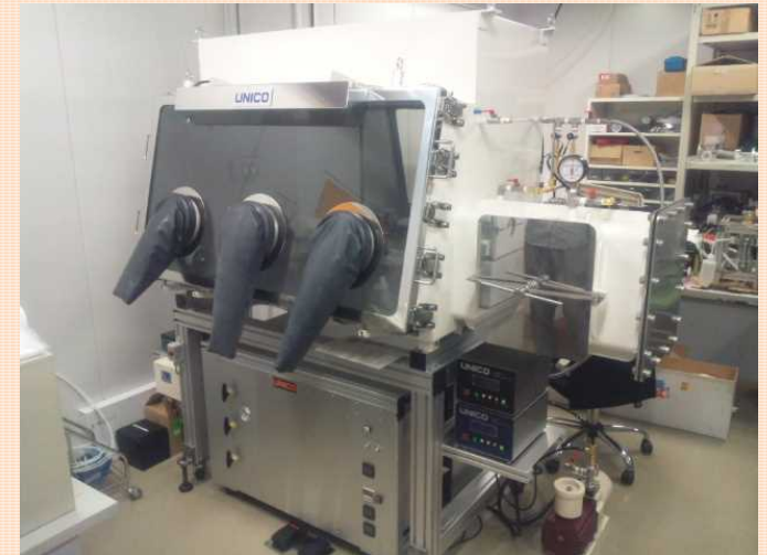
図1-2 不活性雰囲気グローブボックス サンプルのハンドリング・物性測定を容易にしたり、クラスター型地上模擬試験設備の自由度を高めるために使用
