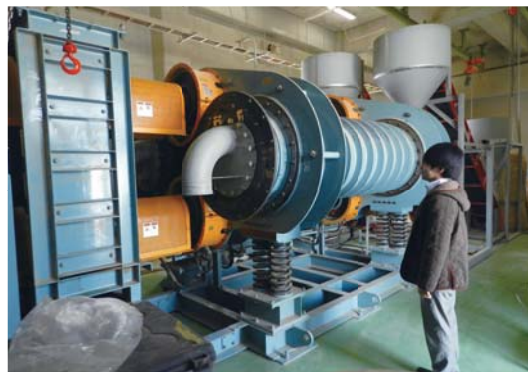
特徴の有る木材微粉砕物を効率的に生産するタンデムリング型微粉砕機
