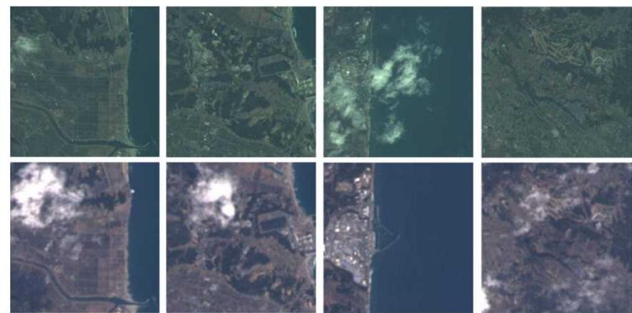
図3.2 ほどよし1号機画像（上段）とLandsat画像（下段）のレジストレーション結果
