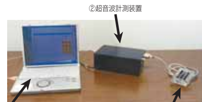
②超音波計測装置 ③膀胱形状・蓄尿量推定アルゴリズム ①超音波センサパッド 尿失禁予知センサ
