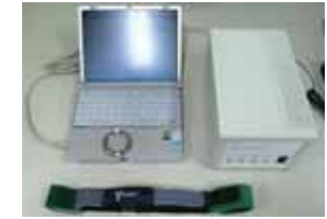
検証用テレメータ生体計測システム
