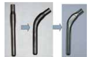
図3 実際の熱間閉塞鍛造加工により製造されたNiフリーCo-Cr-Mo合金製人工股関節ステム
