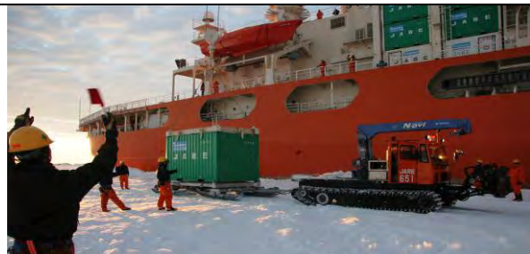
氷上輸送用に導入した雪上車と 12ft コンテナ橇 氷上輸送時間の短縮に大きく貢献した。
