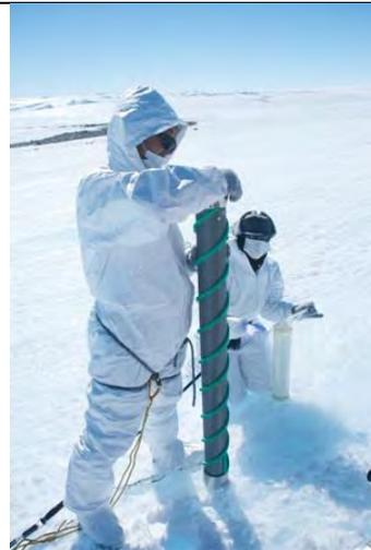
図1. 沿岸氷床域における雪氷サンプリングの様子。コンタミを防ぐため、防寒着の上に白衣を着込んでアイスオーガーを操作する。
