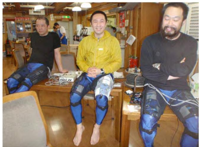
JAXA との共同研究のサブテーマの一つ、「ハイブリッドトレーニング効果の向上に関する研究」の昭和基地での実施状況。ハイブリッド電気刺激を用いた筋屈伸訓練装置による体力維持効果を検証し、遠隔地使用における運用の問題点を明らかにした。
