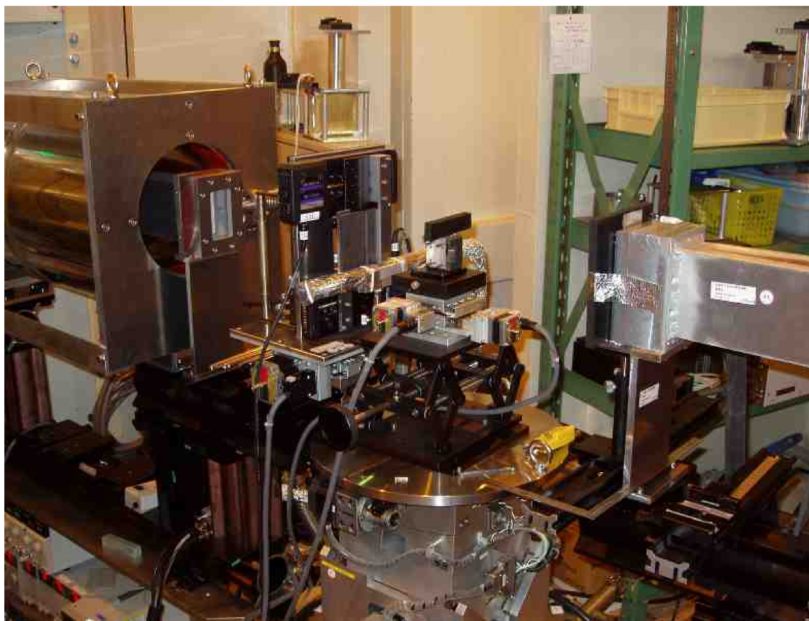
図1 中性子反射率計の外観（左：入射スリット、中央：試料、右：検出器）
