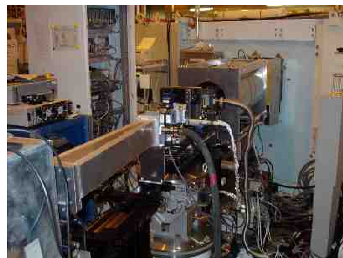
図1 中性子反射率計の外観(左手前:反射側検出器、中央:試料、右奥:入射側検出器)
