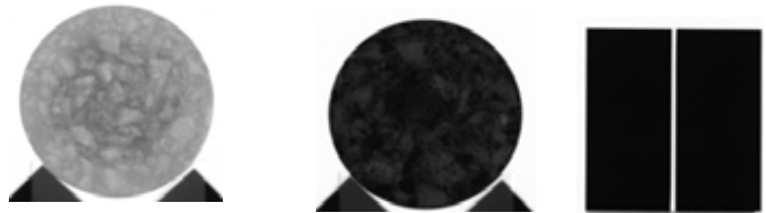
普通コンクリート（表面） ホウ素入りコンクリート（表面） 樹脂系中性子遮蔽材料（表面） 図1 各試験体の中性子ラジオグラフィ画像
