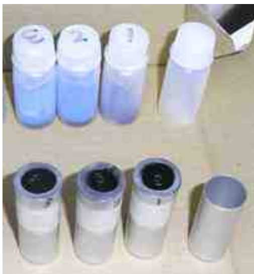
図1 現像剤を封入したサンプル(手前; アルミニウム素材、奥; テフロン素材)
