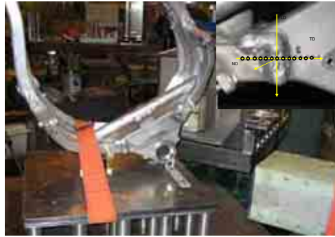
図1 フレーム残留応力測定状況
