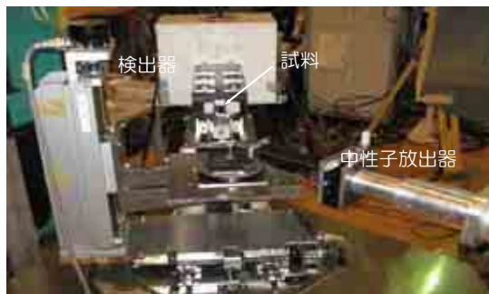
図1 無歪みd0サンプル残留歪み測定状況
