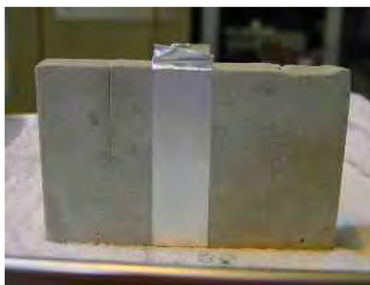
図1 ひび割れスリットを入れたセメントペースト供試体
