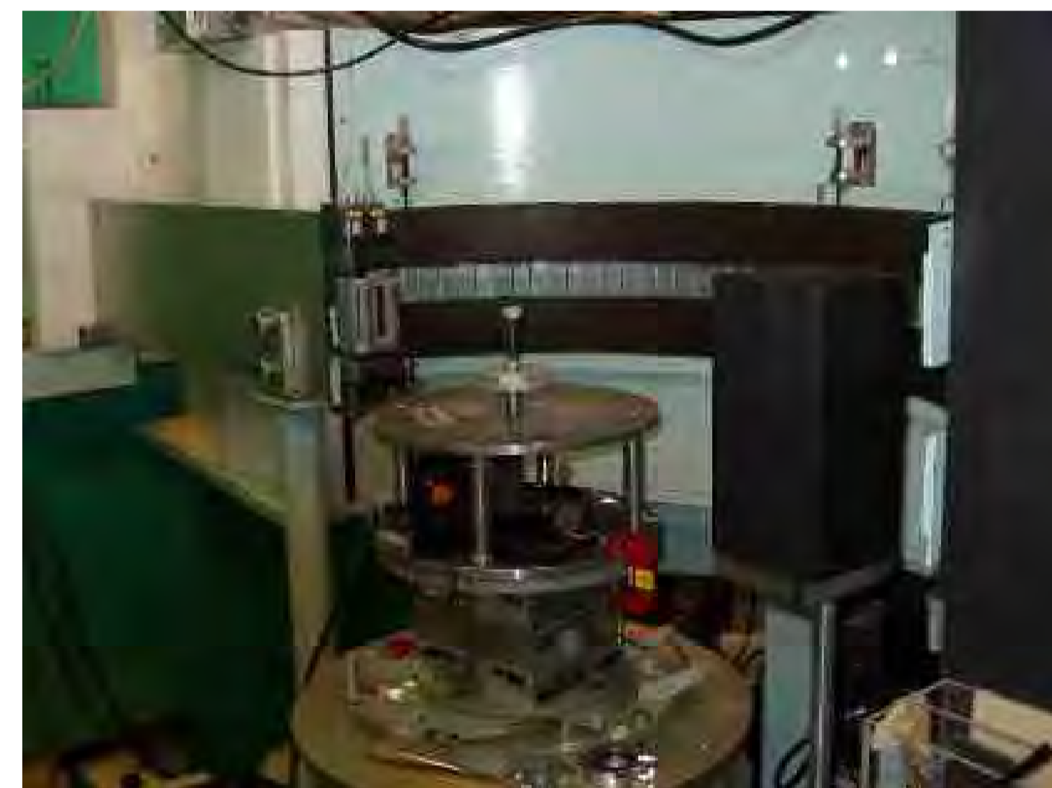
図1 HRPD 測定の外観（左：中性子入射、中央：回転試料台、奥：検出器群、右：ビームストップ（B4C）
