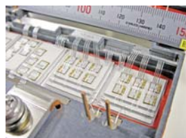
大電力SiCパワーモジュール内部構造
