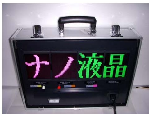
ナノ粒子添加狭ギャップTNフィールドシークエンシャル方式液晶表示パネル試作品
