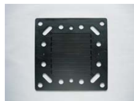
金属セパレータ(反応面積100cm 2 )
