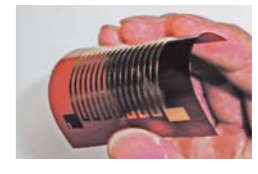
フレキシブルなポリイミド基板への密着性の高い銀ナノ粒子ペースト印刷／銅めっき配線形成
