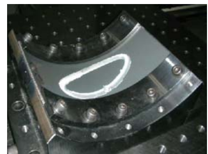
図④/凹円筒内面への傾斜楕円形状の接合例
