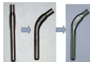
丸棒素材 曲げ加工後 熱間閉塞鍛造加工後 図3 実際の熱間閉塞鍛造加工により製造されたNiフリーCo-Cr-Mo合金製人工股関節ステム
