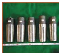
図1(b)導入した真空溶解炉で製造したCo-Cr-Mo合金
