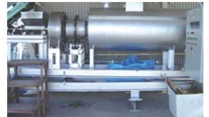
廃棄物炭化処理(還元熱処理)装置 (ロータリーキルン)
