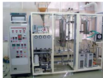
木質バイオマスガス化試験装置
