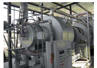
還元熱処理装置(上海交通大学内の実験サイト)
