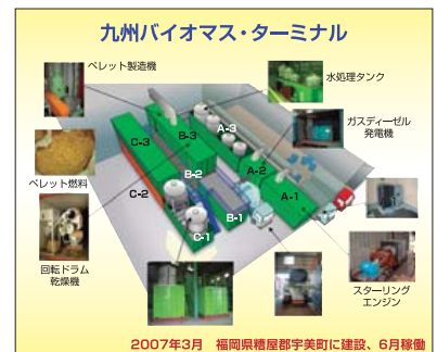
九州バイオマス・ターミナル ハイブリッドバイオマス変換装置全体
