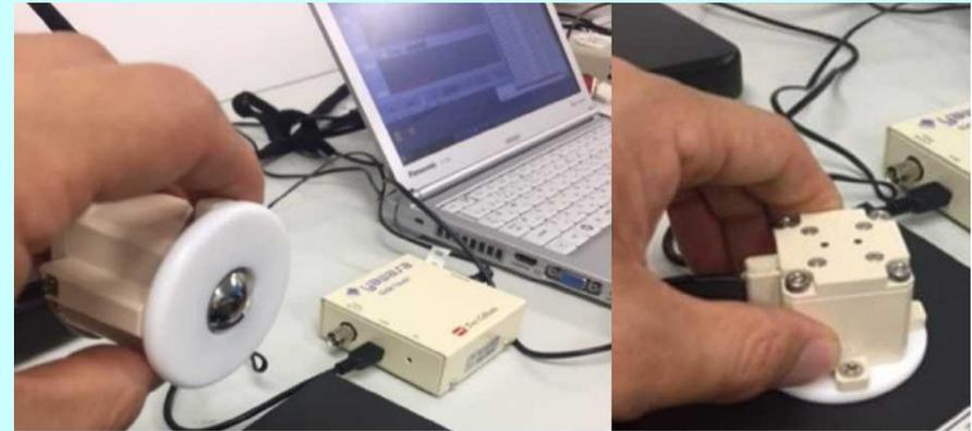
球状(半球状)プローブを試料へ押し当てて得られる3軸力センサーの情報から、ほぼリアルタイムで試料の力学的データを取得できる。システム構成は、本体+アンプBOX+PC(専用ソフト導入済み)のみである。
