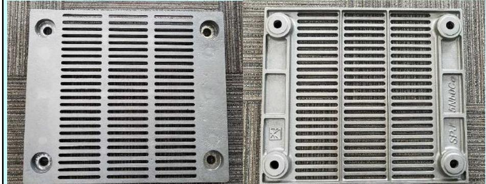
写真1 軽量化を施した耐摩耗コールドスクリーン
