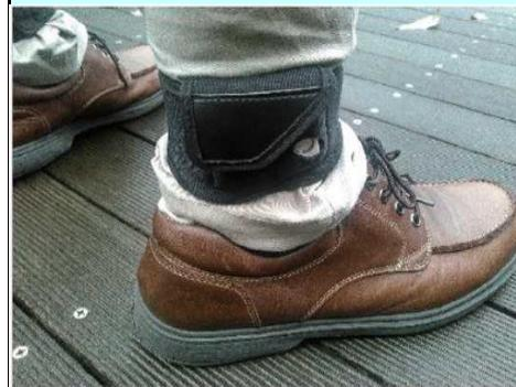
図1. 小型軽量のセンサを取付け、1分程度のセットアップで計測可能
