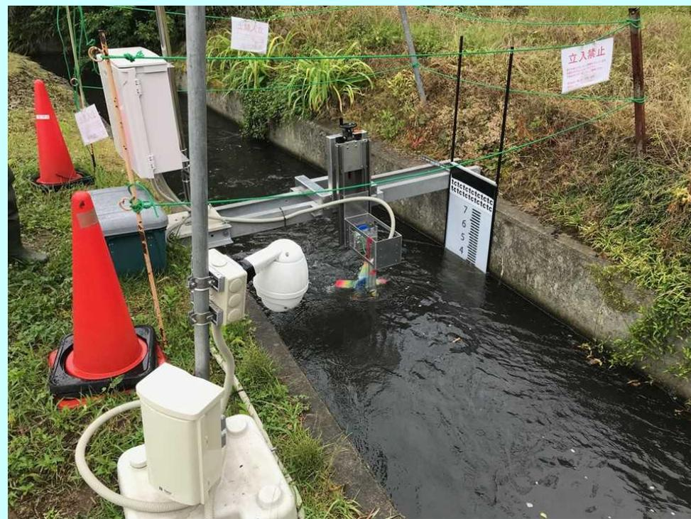
河川に設置した水力発電装置
