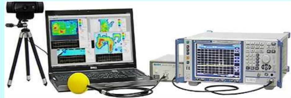
測定対象物が発する低周波磁界の強度のレベルを、パソコンのモニタ上に映した対象物のカメラ画像に重ね合わせてカラー表示するシステム。画像認識技術を使い、磁界センサの位置を把握して磁界空間分布を可視化する
