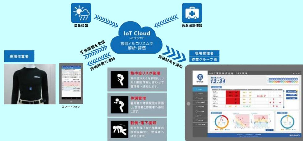
暑熱労働環境の評価システムの概要。作業者の生体情報と位置情報で紐付けられた気象情報を統合して分析する。
