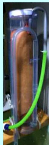
簡易な装置で脱窒(水処理)
