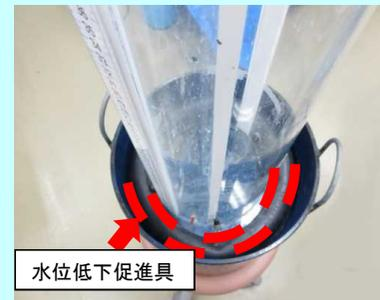
写真2 水位低下促進具の設置状況
