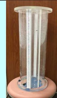
写真1 2重管式試験装置
