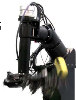
高速多指ハンド・アームによるボールジャグリング
