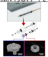
金属ガラス製ダイアフラムを組込 んだ世界最小サイズ高感度自動車 用圧力センサ
