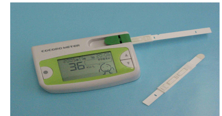
(b) 市販されたストレス測定器 (ニプロ(株)、COCORO METER、 130 × 87 × 40 mm 3 ) 唾液アミラーゼ活性を分析して交感神経活性を評価する携帯式交感神経モニタ
