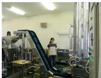
氷結晶部分融解装置を組み込んだ界面前進凍結濃縮法統合システム
