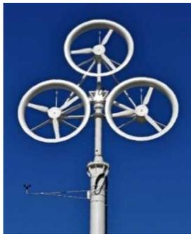
10kWマルチロータレンズ風車の試作機
