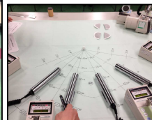
放射線の測定実習 線源を用い、距離の逆二乗則の実習
