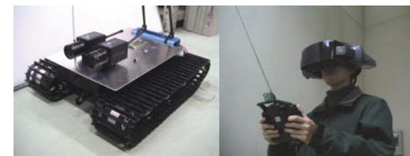
移動ロボットと操縦インタフェース
