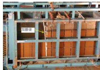
矢板式護岸の側方流動実験状況
