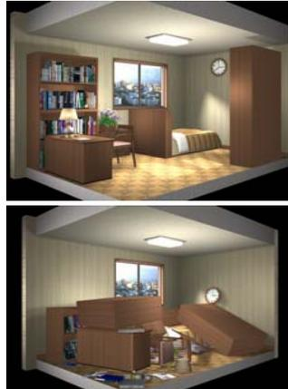
地震時の家具の動的挙動シミュレータ
