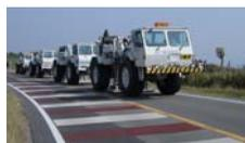
パイロサイス車による発振（弾性波を地下に送り込む）
