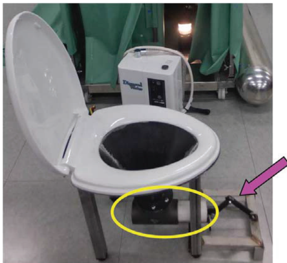
図 51 便座の押し出し機構
