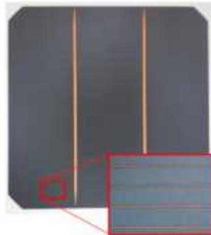
スクリーン印刷後のCu集電電極
