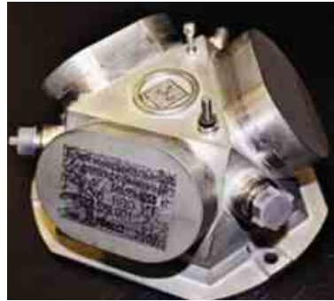
Fibre optic gyroscope を基盤にした非プラットフォーム型慣性ブロック
