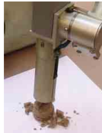
コレット型土壌採取装置 (開発者-宇宙研究所)
