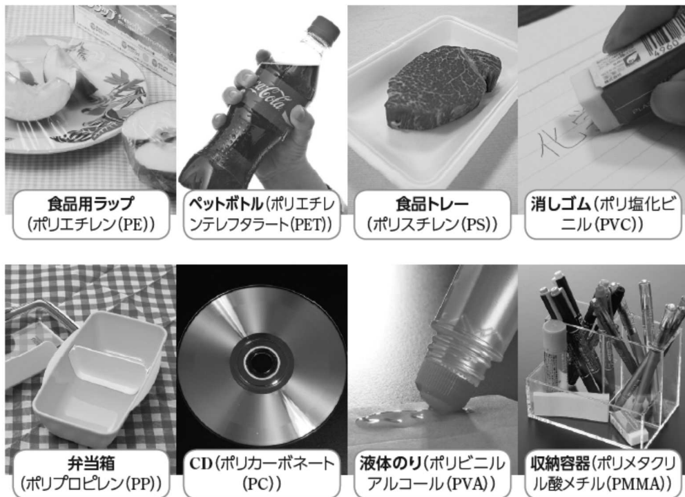
図3 プラスチックの利用例 ( )内はプラスチックの種類と略号
