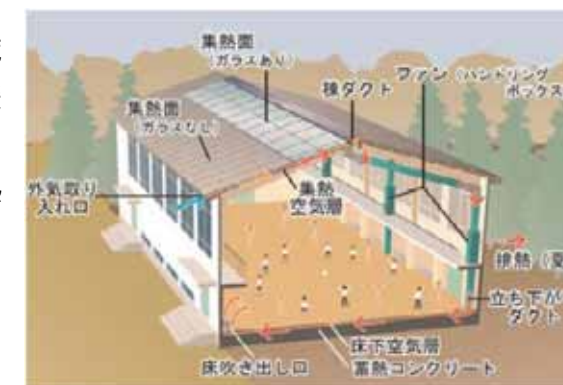
写真．空気集熱式ソーラーシステムの概念図
